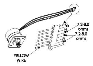
Figure 3-8. Stepper Motor.
